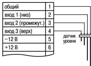
Рисунок 5.3 – Схема подключения кондуктометрических датчиков уровня
